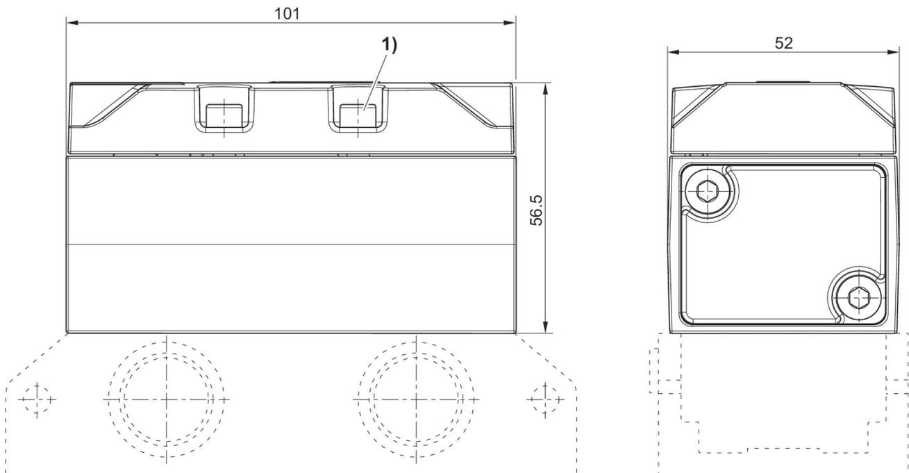
1) Torque de aperto para parafusos de fixação:  $5,5 \pm 0,5$  Nm
