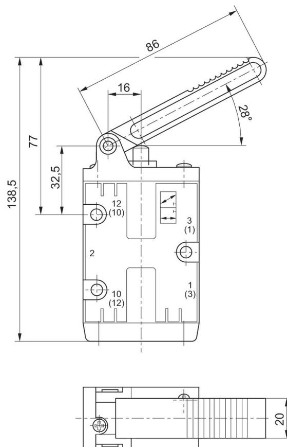
Las dimensiones de la válvula básica son válidas para todos los tipos de accionamiento.
