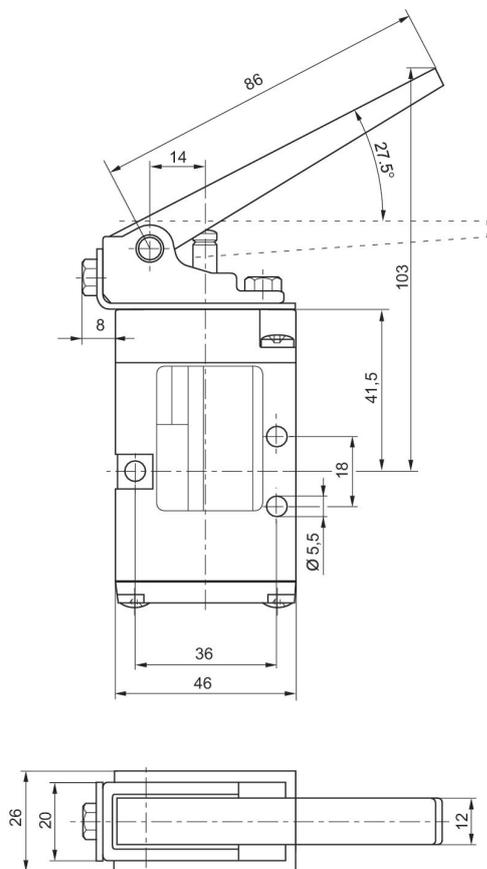
Las dimensiones de la válvula básica son válidas para todos los tipos de accionamiento.
