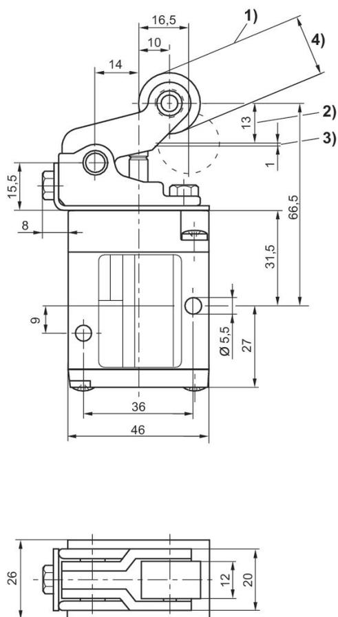
1) angolo di avvicinamento del rullo di comando 30° 2) corsa 3) sovraccorsa
