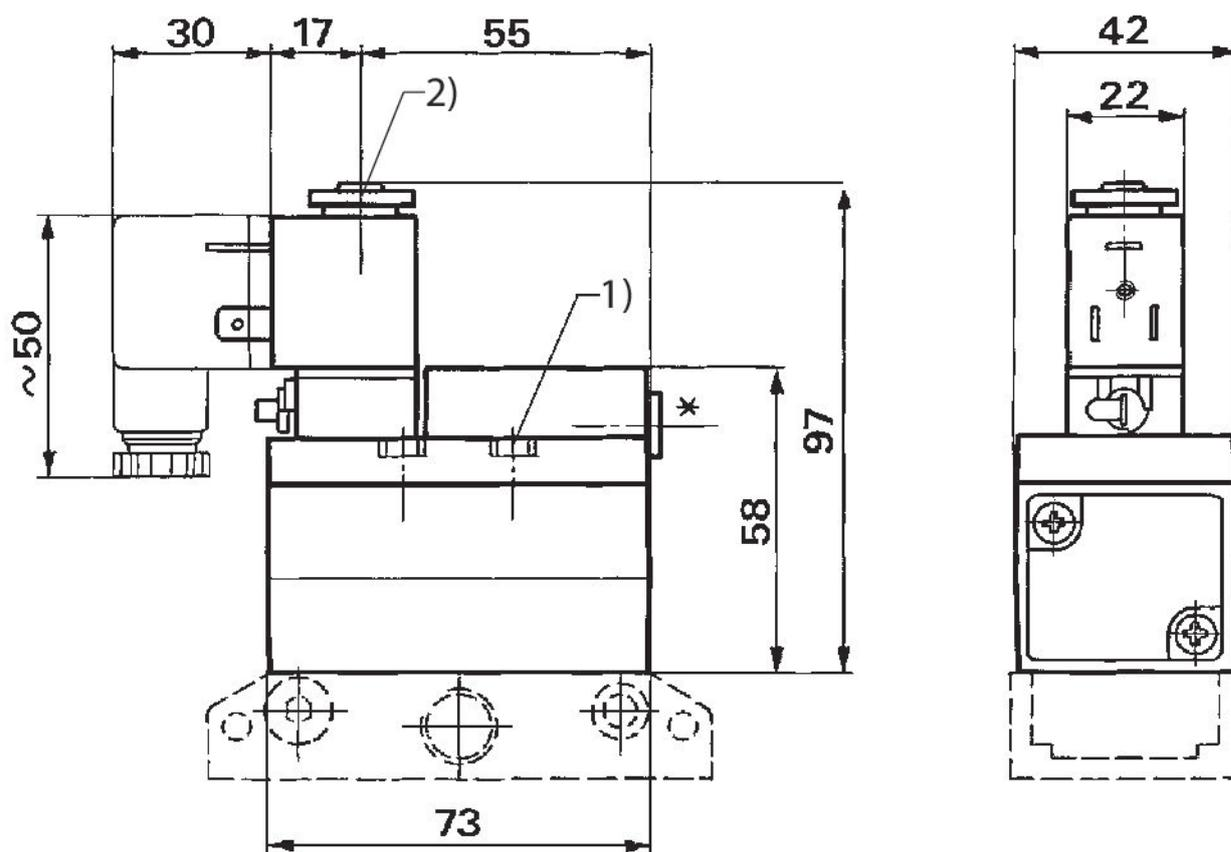
1) Couple de serrage des vis de fixation :  $2,7 \pm 0,3$  Nm
