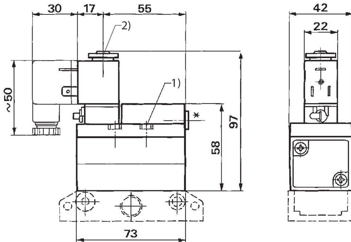
1) Torque de aperto para parafusos de fixação:  $2,7 \pm 0,3$  Nm
