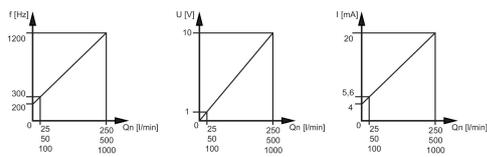
La señal de salida del caudalímetro se puede elegir libremente como señal de frecuencia, tensión o corriente. El blindaje se encuentra en la carcasa del conector.
