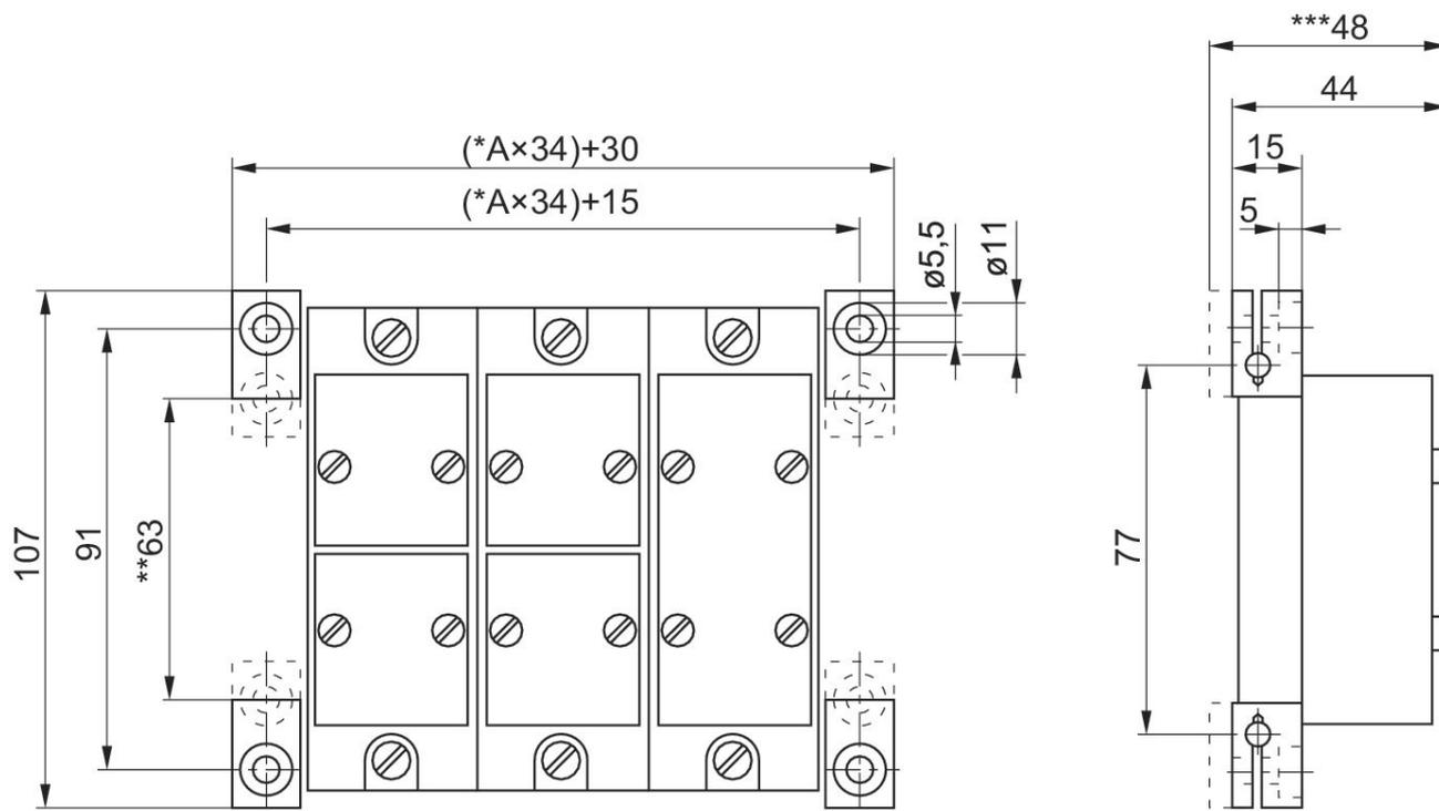
\* A = サブベースの数。 \*\* 内側向きの取付け穴付き。 \*\*\* 180° 向きを変えた取付け穴付き。
