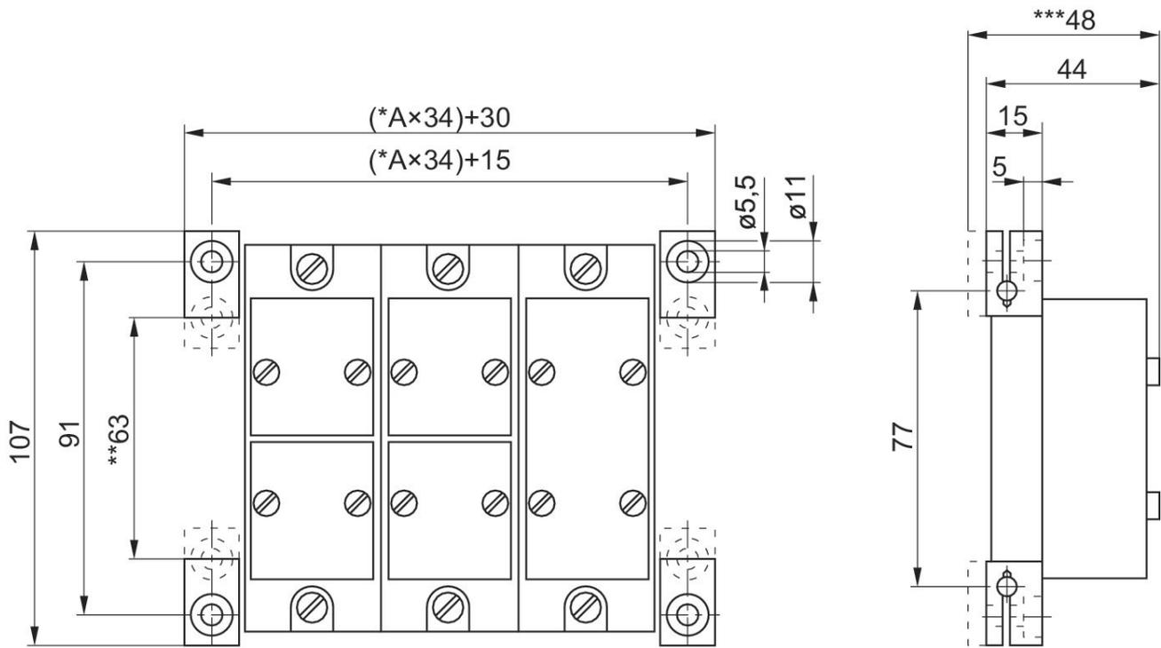
\* A = Anzahl Anschlussplatten. \*\* Mit innenliegenden Befestigungslöchern. \*\*\* Mit um 180° gewendeten Befestigungen.
