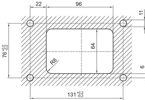
placa de fijación máx. 7 mm de grosor
