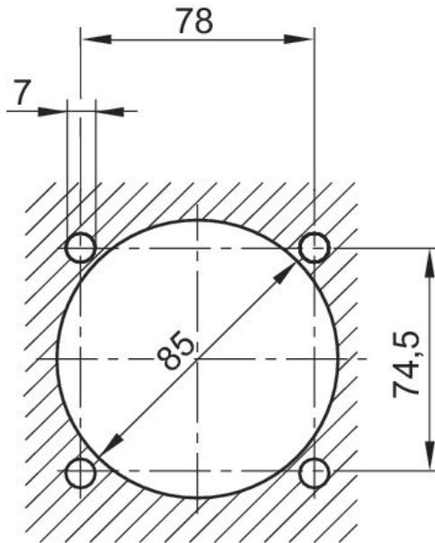
placa de fijación máx. 10 mm de grosor
