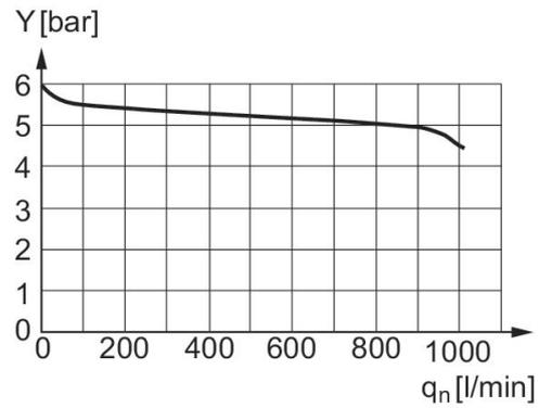
presión de entrada: 8 bar, presión de alimentación: 6 bar y: presión en conducto "A" [bar]
