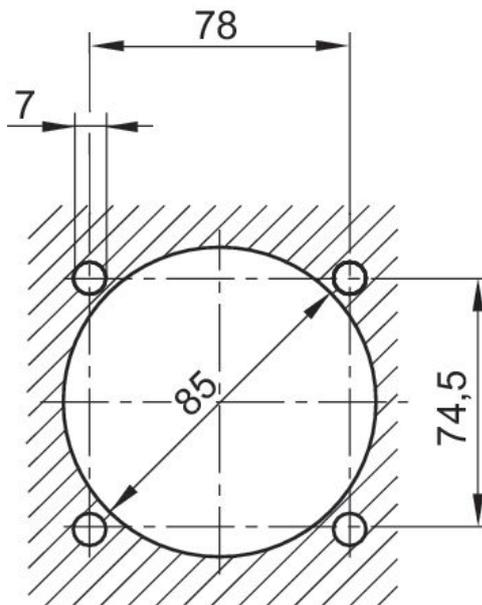
Plaque de fixation, épaisseur max. 10 mm
