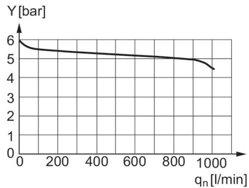
Pression d'entrée : 8 bar, pression d'alimentation : 6 bar y : pression dans le conduit "A" [bar]
