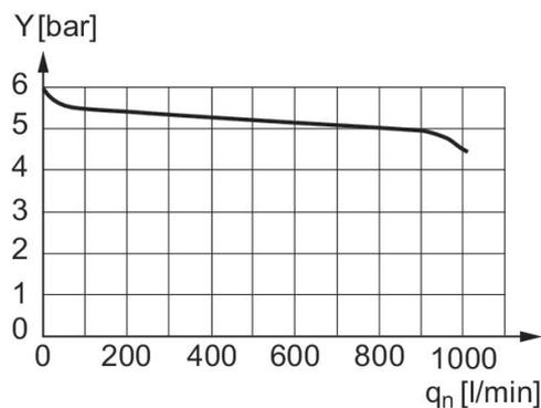
pressione d'ingresso: 8 bar, pressione di alimentazione: 6 bar y: pressione nella linea "A" [bar]
