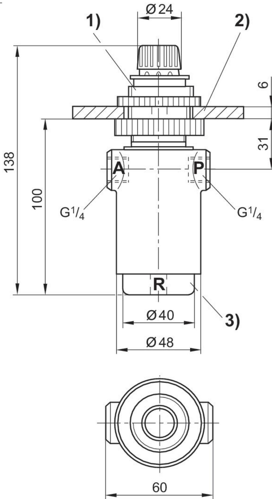
1) Dopo aver sollevato l'anello di arresto può essere regolato il volantino. 2) foro per la piastra di fissaggio  $\text{Ø}31$  mm 3) coperchio a vite
