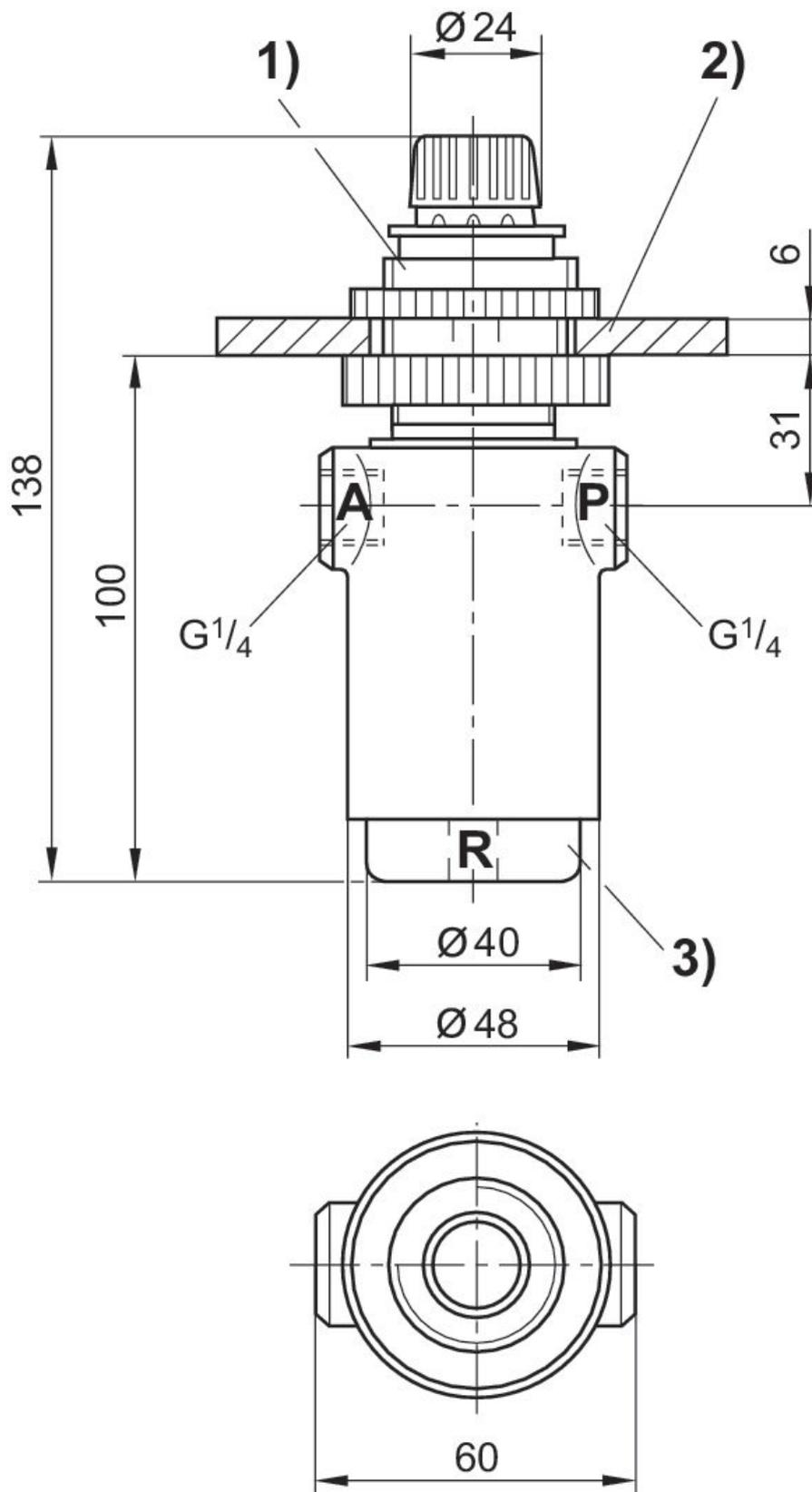
1) Después de desplazar hacia arriba el anillo de retención, se puede regular el volante. 2) agujero para la placa de fijación  $\text{Ø}31$  mm 3) tapa roscada
