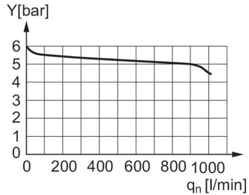
Pression d'entrée : 8 bar, pression d'alimentation : 6 bar y : pression dans le conduit "A" [bar]
