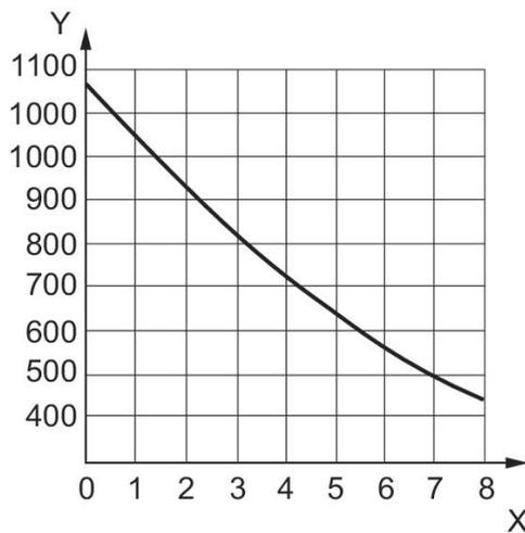
Das Diagramm gilt bei max. 20° C Umgebungstemperatur. x: Betriebsdruck p [bar] y: Drehzahl n [U/min.]
