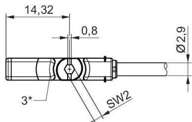
1\* = Ponto de comutação 2\* = Parafuso de retenção 3\* = Janela LED translúcida
