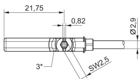
1\* = Ponto de comutação 2\* = Parafuso de retenção 3\* = Janela LED translúcida
