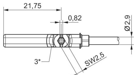
1\* = Ponto de comutação 2\* = Parafuso de retenção 3\* = Janela LED translúcida
