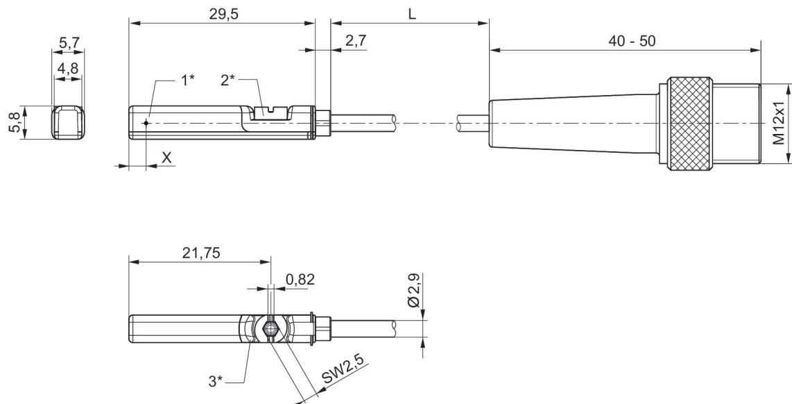
1\* = Ponto de comutação 2\* = Parafuso de retenção 3\* = Janela LED translúcida
