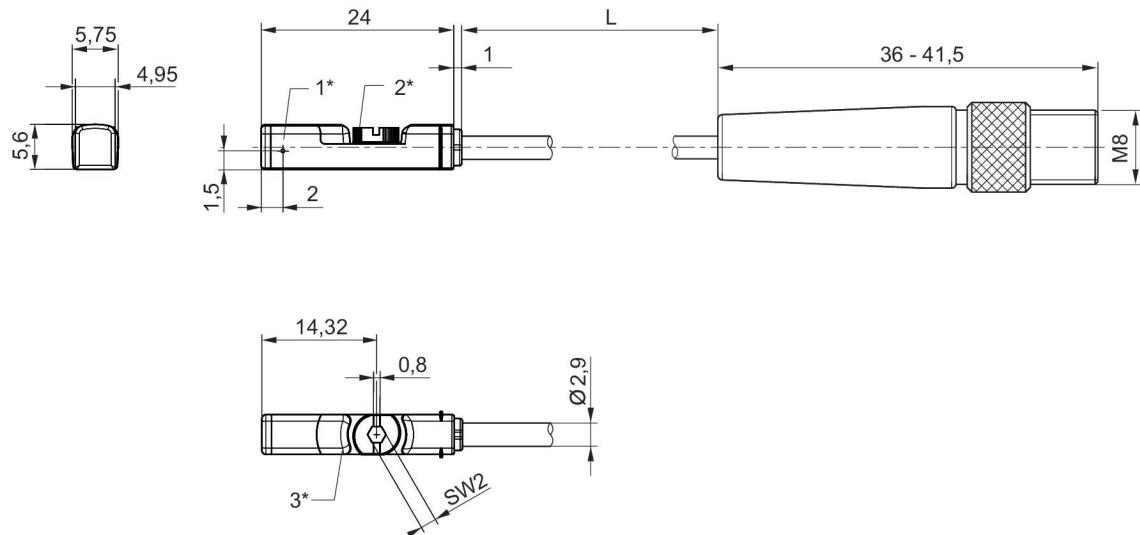
1\* = Ponto de comutação 2\* = Parafuso de retenção 3\* = Janela LED translúcida
