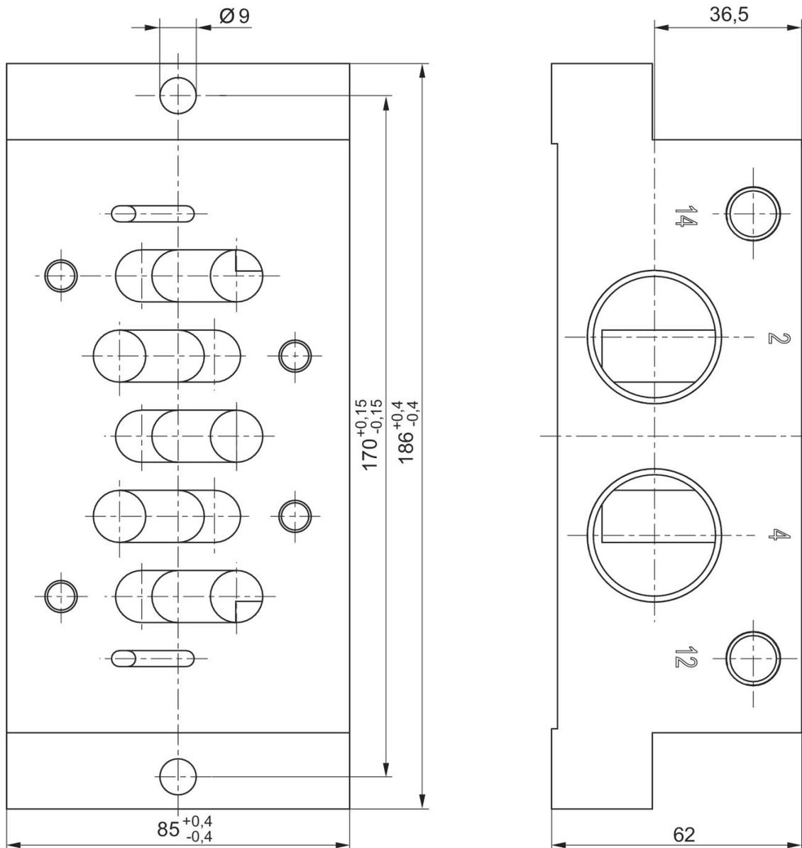
单个底板, 侧面的螺纹接口
