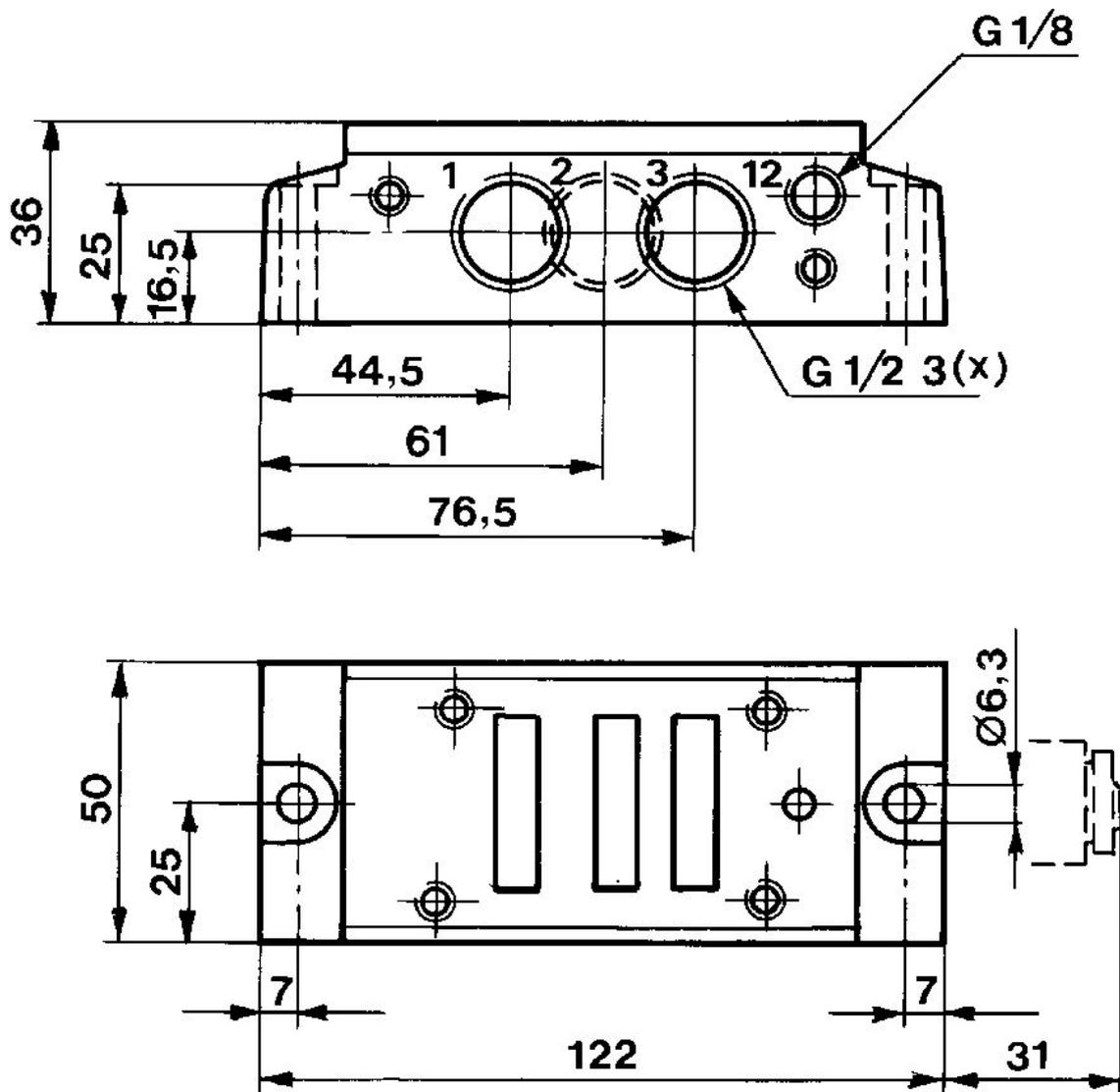
单个底板, 侧面的螺纹接口
