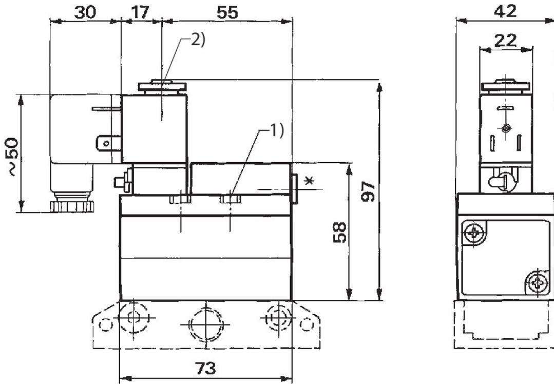
1) 固定螺栓的拧紧力矩：  $2.7 \pm 0.3$  Nm
