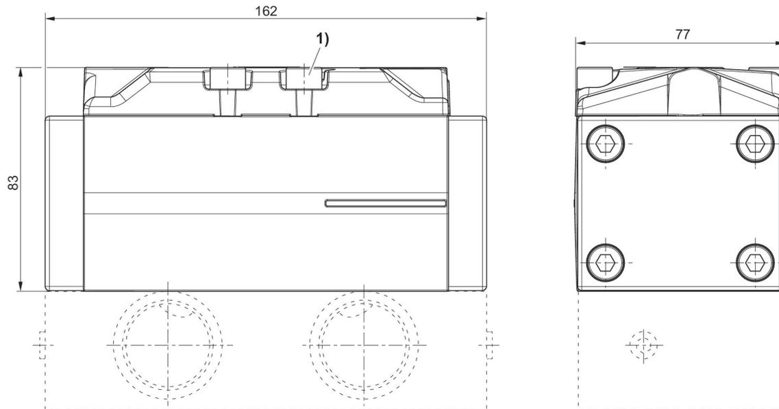
1) 固定螺栓的拧紧力矩:  $22 \pm 2$  Nm
