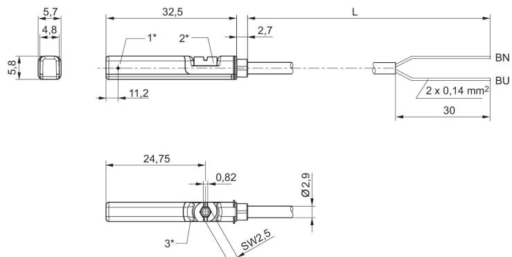
1\* = punto di commutazione 2\* = vite di arresto 3\* = finestra LED trasparente
