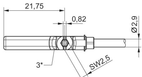
1\* = punto di commutazione 2\* = vite di arresto 3\* = finestra LED trasparente
