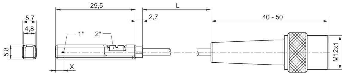
1\* = punto di commutazione 2\* = vite di arresto 3\* = finestra LED trasparente
