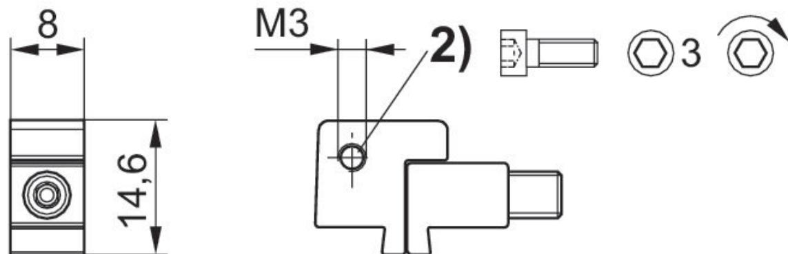
1) vite di bloccaggio 2) vite di fissaggio per sensore 3) sensore
