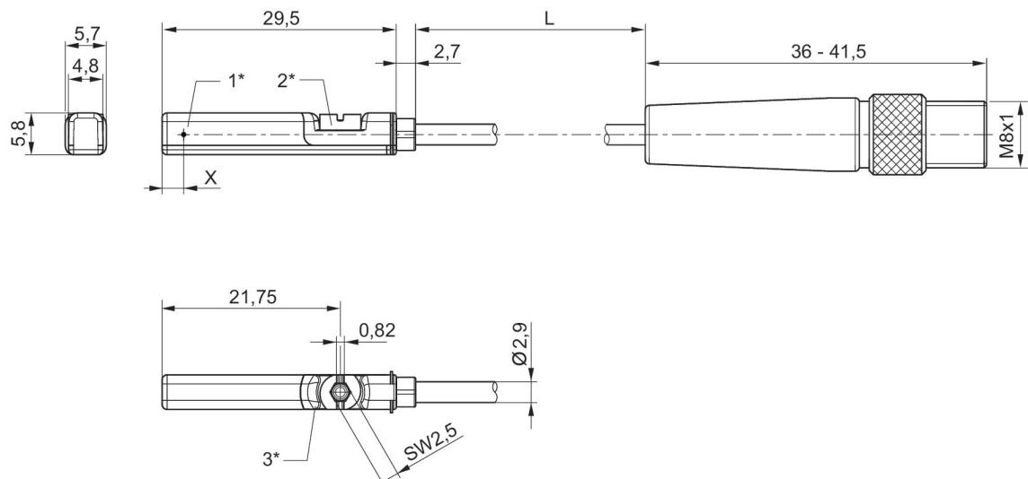
1\* = punto di commutazione 2\* = vite di arresto 3\* = finestra LED trasparente
