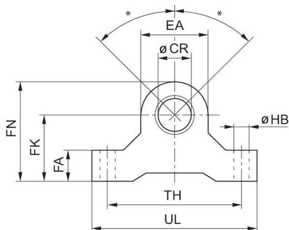
\* クレビス型シリンダ-MP6の最大往復移動幅:  $\pm 45^\circ$
