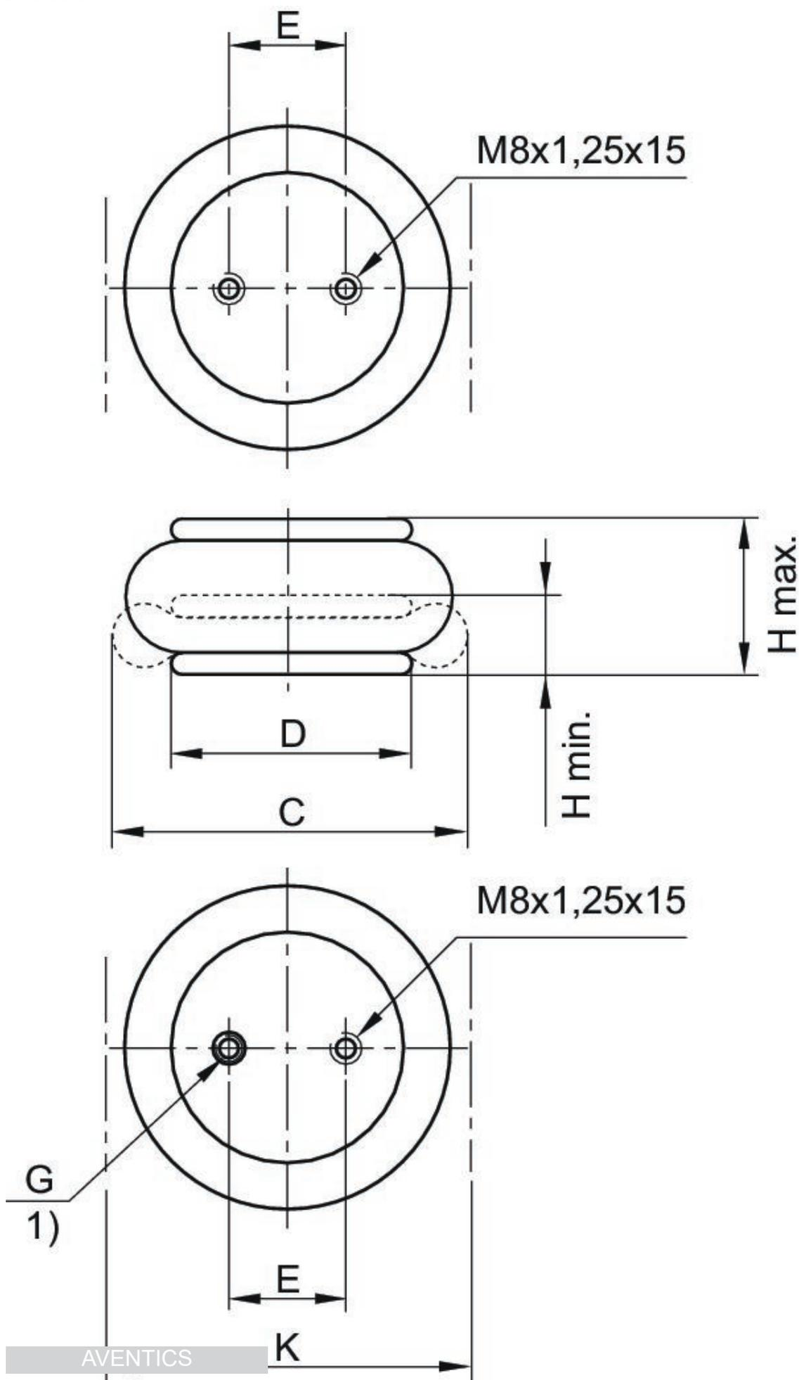
1) "Raccordement de l'air dans l'alésage de fixation "
