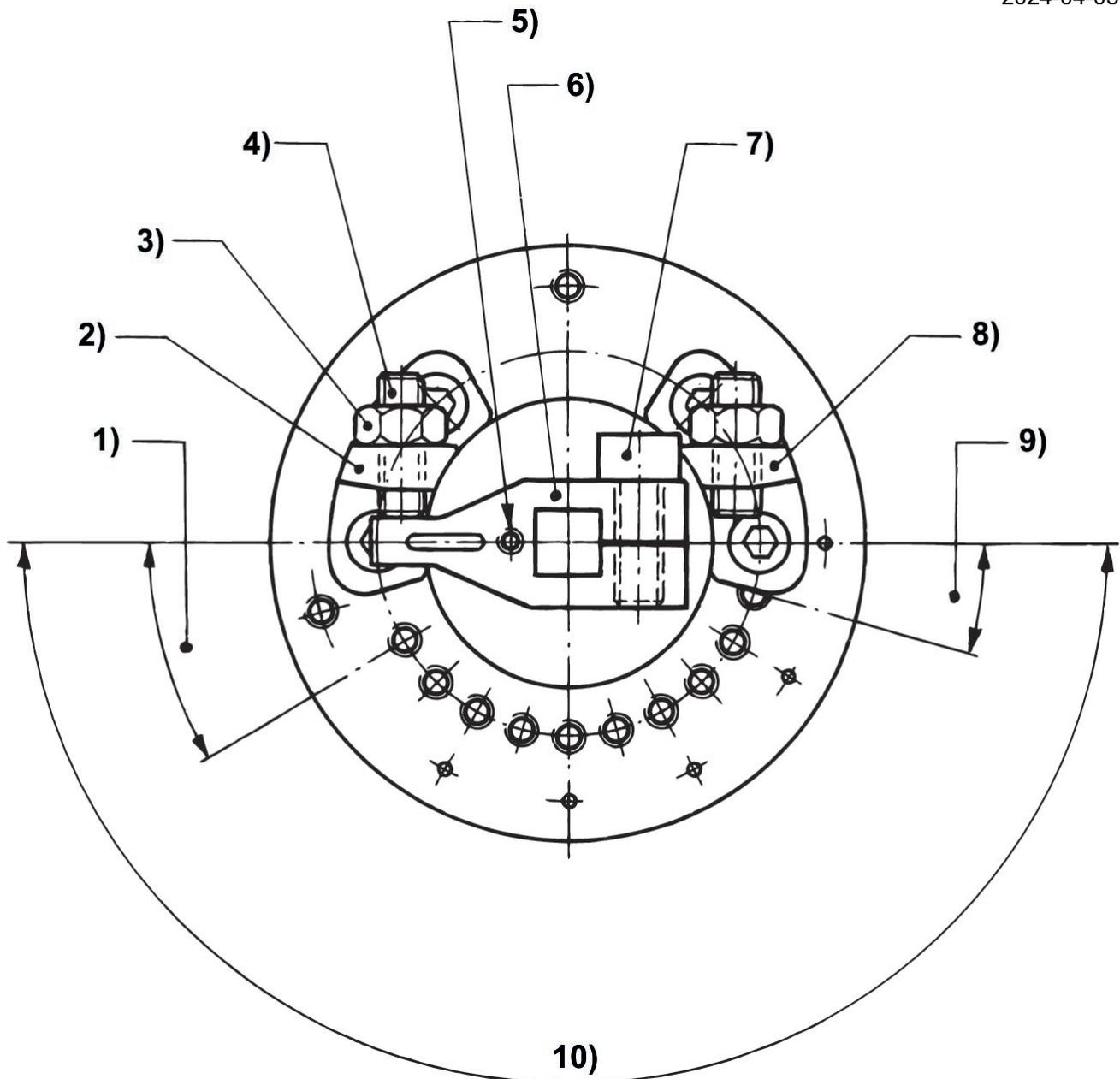
1) Réglage de l'angle de rotation min. 30° 2) Limitation du point de référence 3) Contre-écrou 4) Vis de réglage de précision 5) Trou pour aimant 6) Bras pivotant 7) Vis de réglage pour bras pivotant 8) Limitation du réglage de l'angle de rotation 9) Ecart à la butée de fixation 15° 10) Angle de rotation
