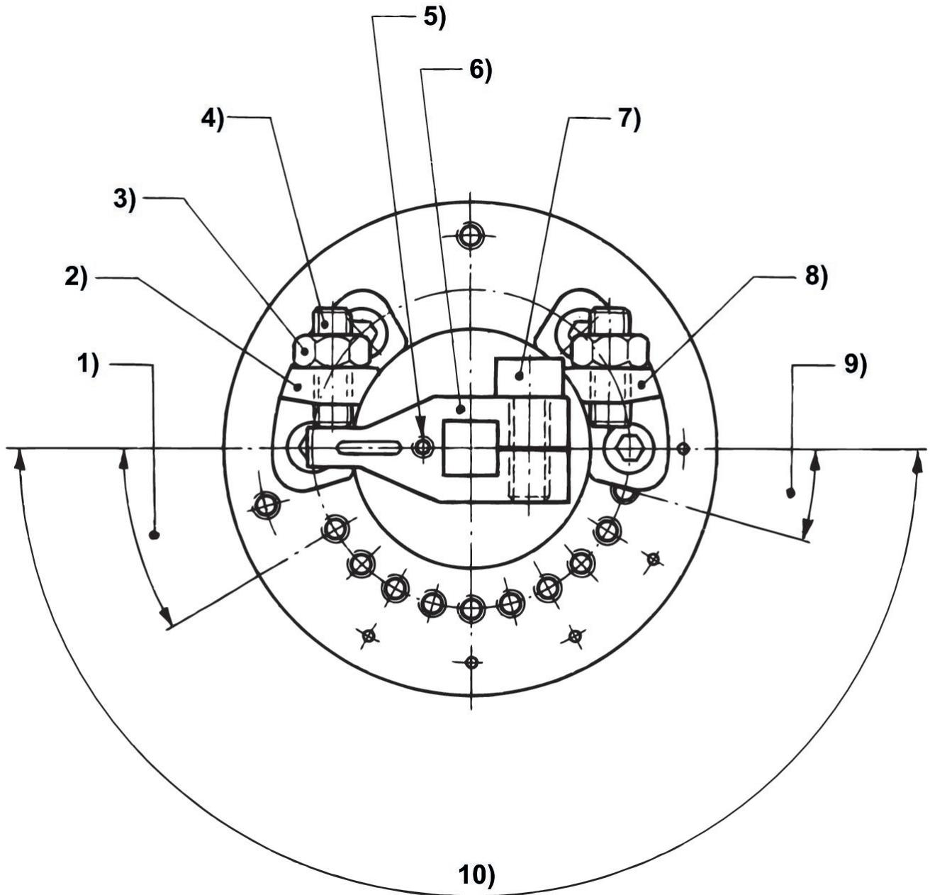
1) Regolazione dell'angolo di rotazione min. 30° 2) Limitazione punto di riferimento 3) Controdado 4) Vite di regolazione fine 5) Foro di fissaggio per magneti 6) Braccio oscillante 7) Vite di regolazione per braccio oscillante 8) Limitazione della regolazione dell'angolo di rotazione 9) Distanza battuta di fissaggio 15° 10) Angolo di rotazione
