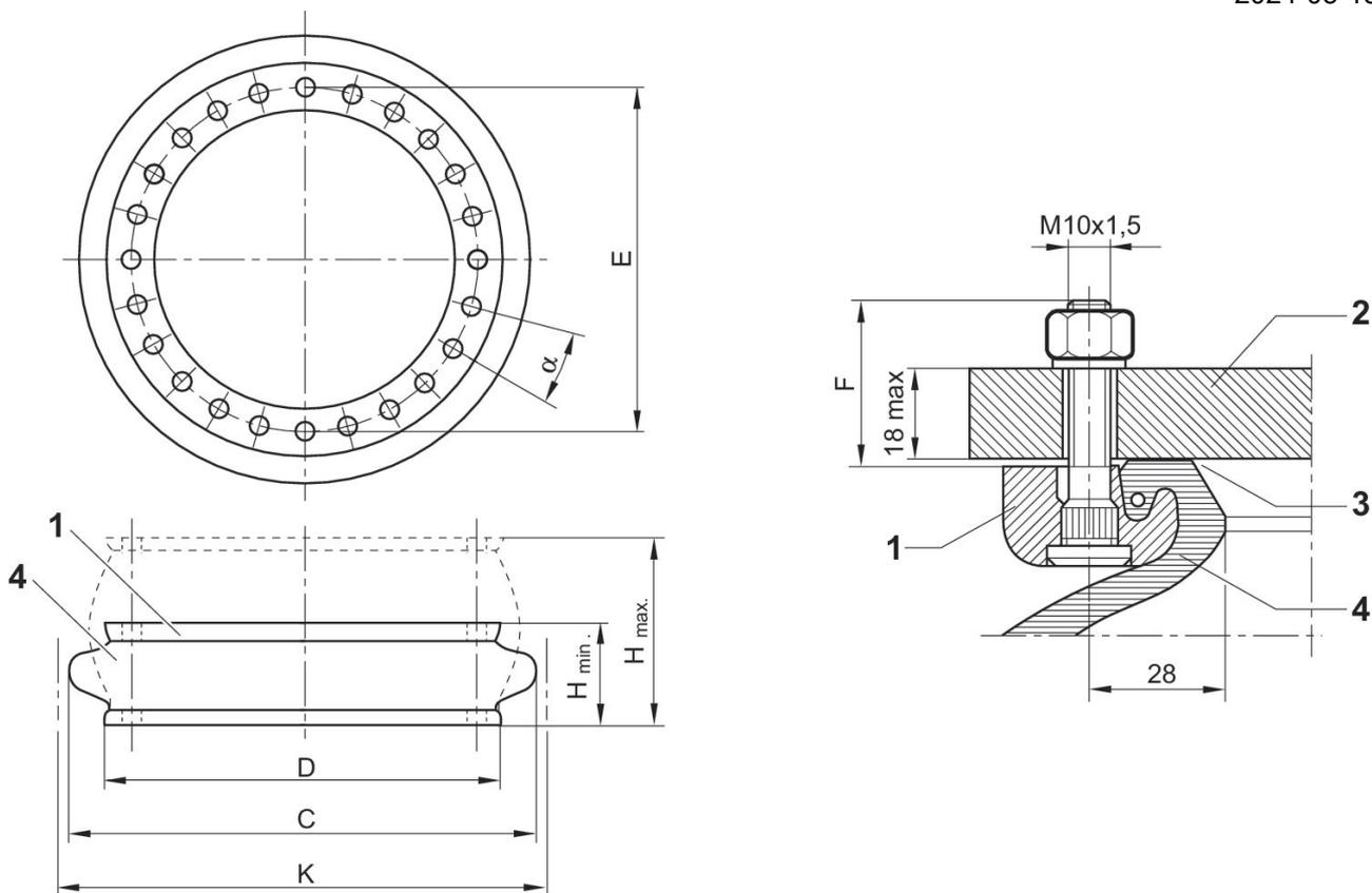
sezione parziale dell'anello di fissaggio con tirante a vite 1. anello di fissaggio 2. parte della macchina 3. superficie di tenuta \*) 4. soffietto \* consiglio della finitura superficiale: per superficie a lavorazione circolare: Ra 6 per superficie a lavorazione rettilinea: Ra 0,8 coppia di serraggio adatta M8: 25 Nm, M10: 40 Nm, M16: 70 Nm raccordo pneumatico nella parte di fissaggio
