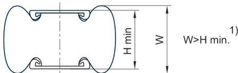
1) 最低高さ H min. に達したら、突起の高さ W は、下限を下回る可能性があります。これらの製品に対し、カバー直径より大きい水準取付け面が選択されている場合、ストローク開始の戻り力および力の出力は上昇します。また、この過程において、ゴムベローは取付け面により圧縮されます。これらの製品は、上向きのスペースを多く必要とし、まれに障害を引き起こすおそれがあります。いかなる場合にも、ベローアクチュエータのカバーのサイズで取付け面を使用する場合、データシートの仕様が適用されます。
