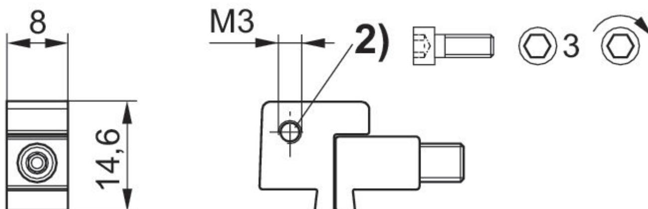
1) parafuso de aperto 2) parafuso de fixação para sensor 3) sensor
