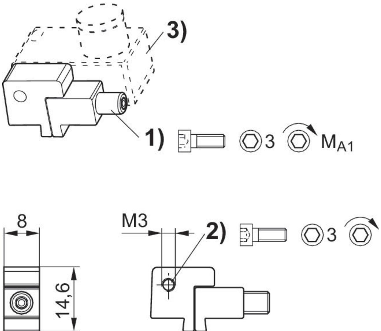
1) Klemmschraube 2) Befestigungsschraube für Sensor 3) Sensor
