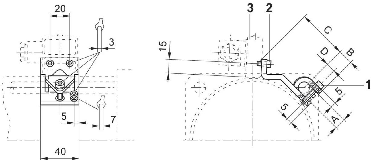
1) Befestigungsschraube 2) Befestigungsschraube für Sensor 3) Sensor
