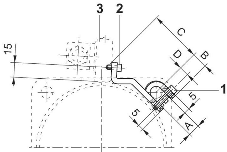
1) 固定ねじ 2) センサー用固定ねじ 3) センサー
