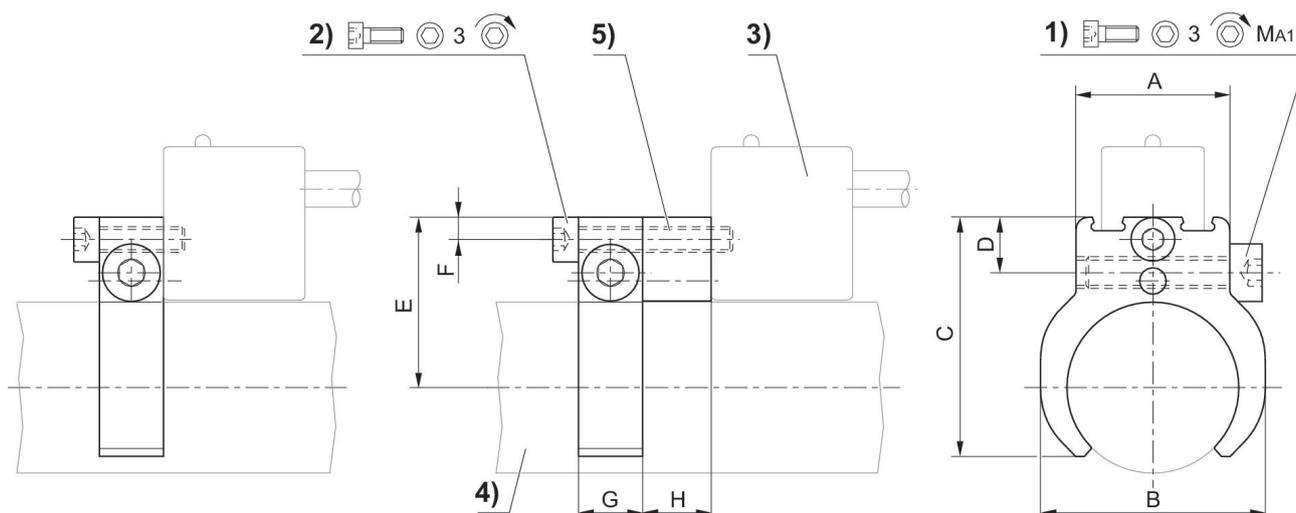
1) Vis de serrage 2) Vis de fixation pour capteur 3) Capteur 4) Profil de vérin 5) Pièce intermédiaire (si nécessaire)
