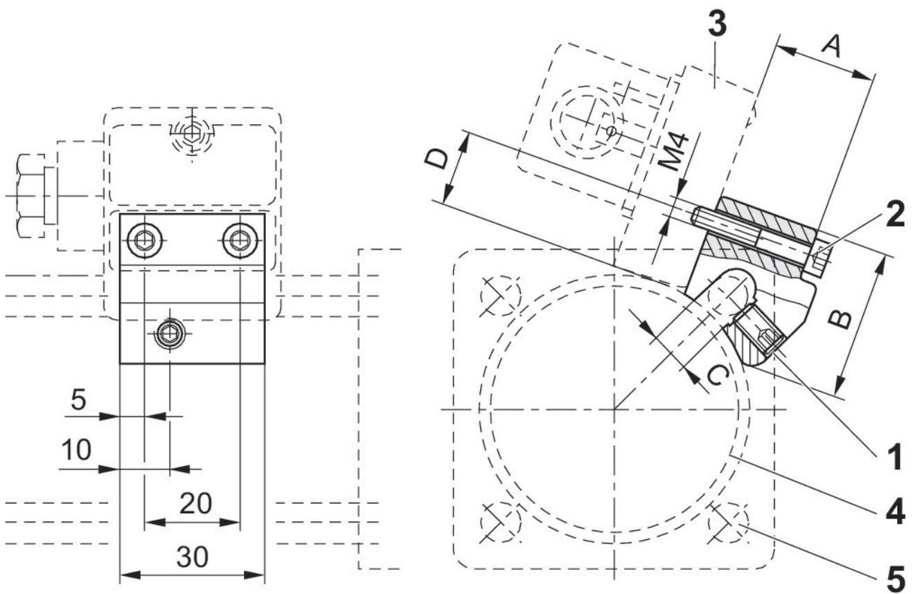
1) Klemmgewindestift 2) Befestigungsschraube für Sensor 3) Sensor 4) Zylinderprofil 5) Zuganker
