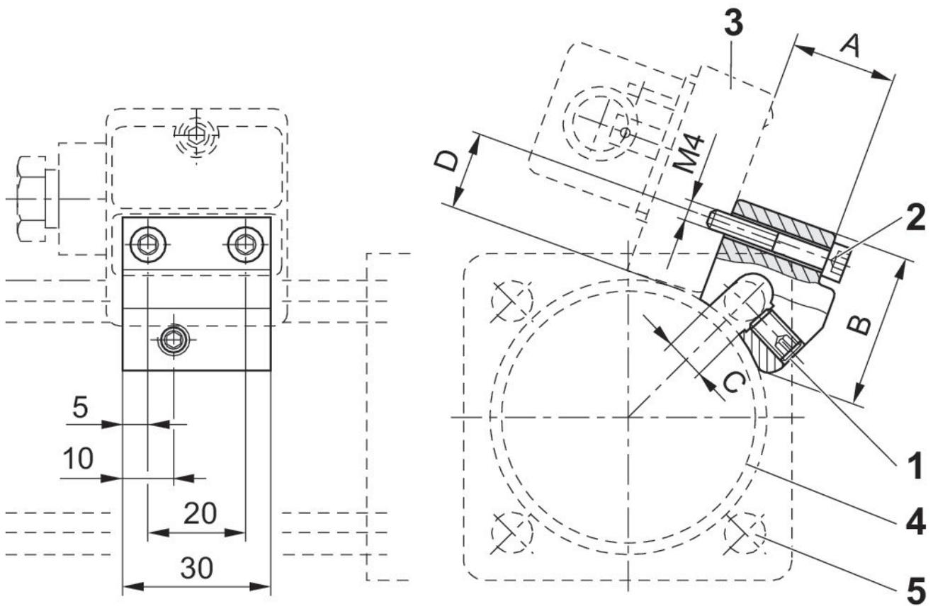
1) prigioniero di fissaggio 2) vite di fissaggio per sensore 3) sensore 4) profilato cilindro 5) tirante
