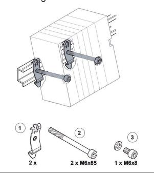
Lieferumfang: (1) 2 Klemmhalter, (2) 2 Schrauben M6x65, (3) 1 Schraube M6x8
