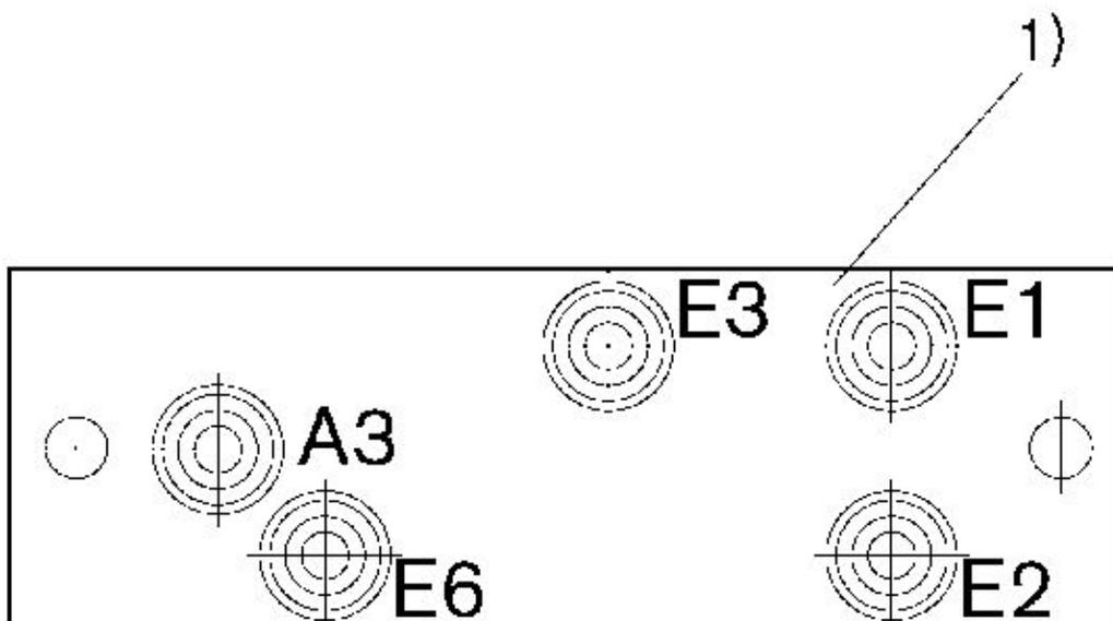
1) 4 x Schraube mit Schlitz DIN 84-84-4,8 - M4 x 22
