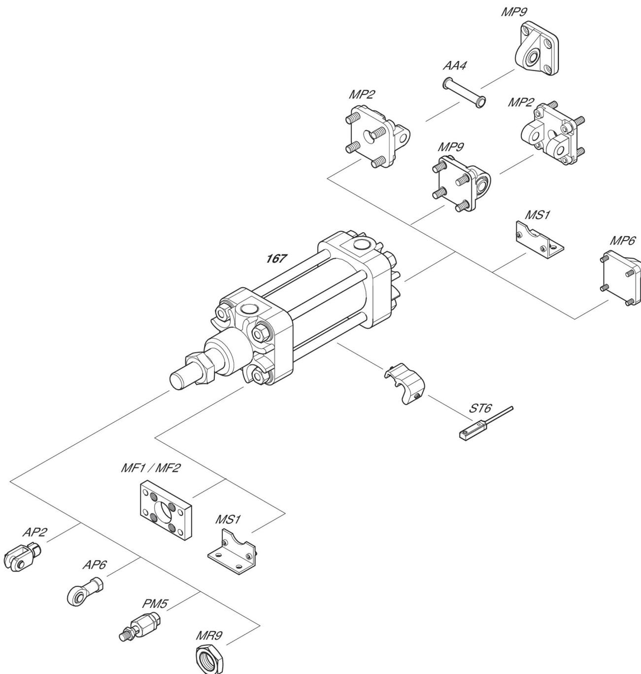
NOTA: Questo disegno di riepilogo serve da orientamento per il punto di fissaggio dei diversi accessori al cilindro. Per questo'illustrazione è stata semplificata. Non sono consentite deduzioni concrete di dati di misurazione.
