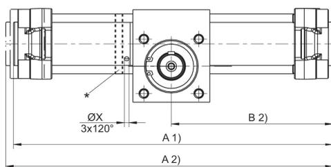
\* Regolazione dell'angolo di rotazione tramite torsione dell'apposito anello. Per farlo è necessario svitare i dadi a colletto dei tiranti e stringerli di nuovo con coppia Ma. Posizione 0: linguetta di aggiustamento sopra (pistone arrestato a destra).
