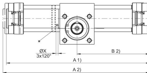
\* Drehwinkeleinstellung durch Verdrehen des Einstellringes. Dabei müssen die Halsmuttern der Zuganker gelöst und wieder mit dem Moment  $M_a$  angezogen werden. 0-Lage: Passfeder oben (Kolben rechts angeschlagen).
