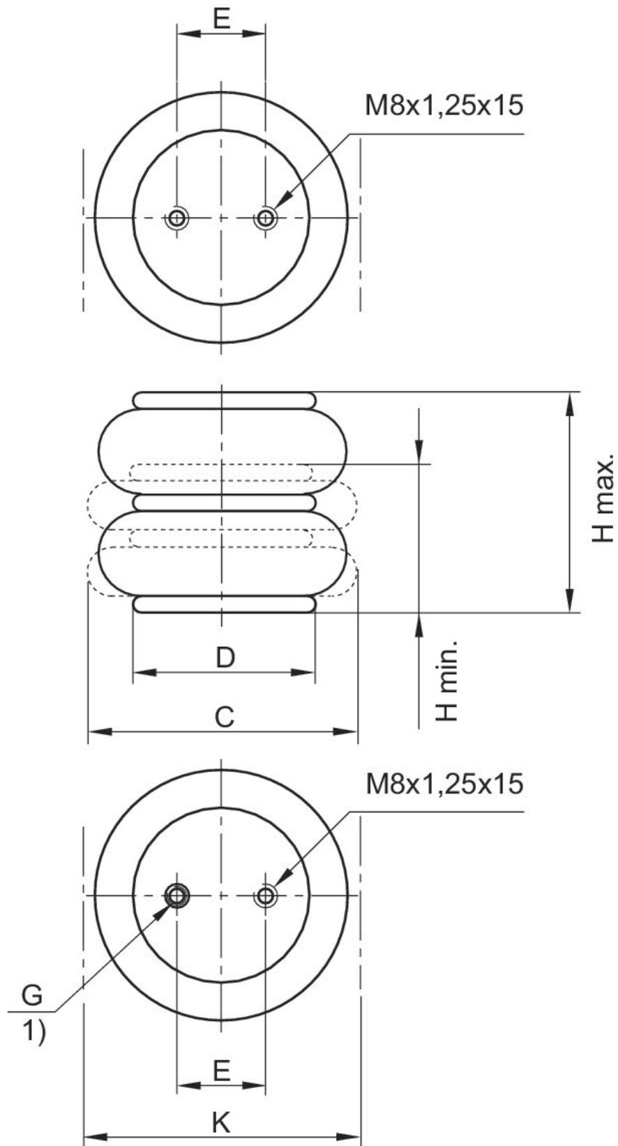
1) "Raccordement de l'air dans l'alésage de fixation "
