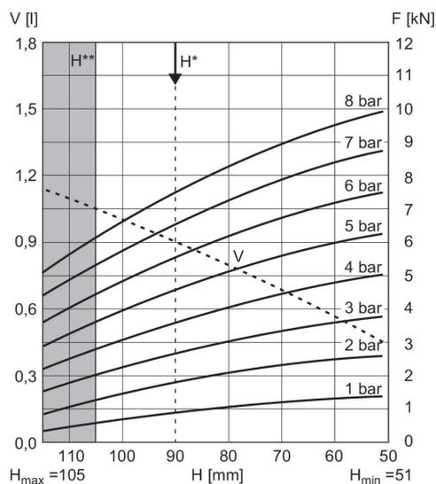
V = Volume H = Altura H\* = Altura de operação recomendada para isolamento da vibração H\*\* = Utilização apenas após contato com a AVENTICS
