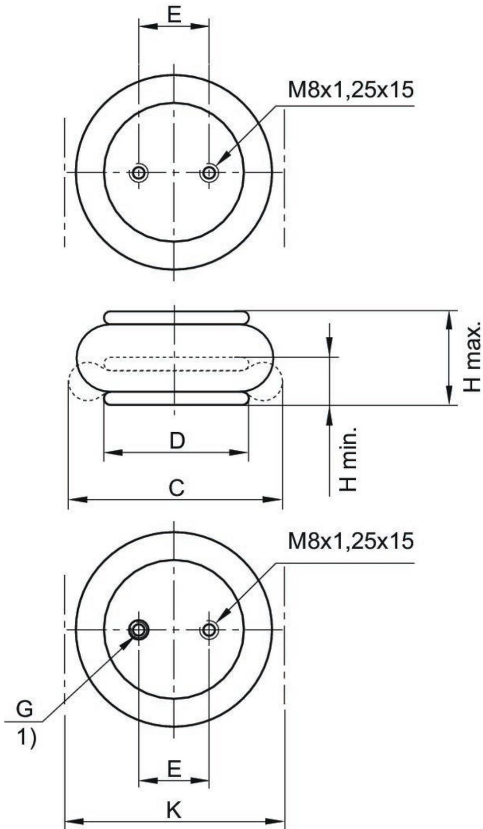
1) raccordo pneumatico nel foro di fissaggio
