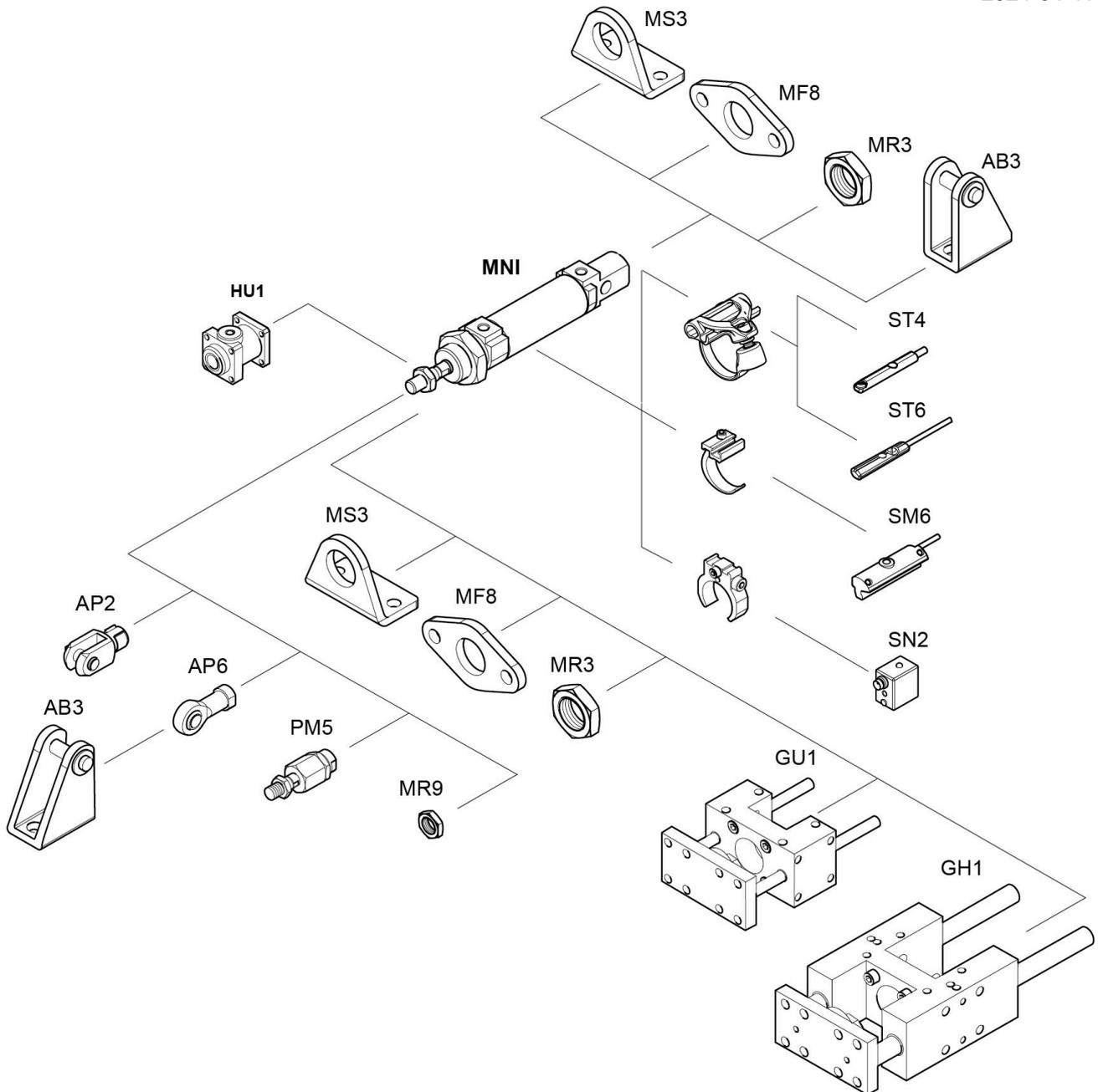
NOTA: Este desenho com uma vista geral serve como orientação para os locais onde os diferentes acessórios podem ser fixados no cilindro. A ilustração foi simplificada para este fim. Por isso, não devem ser tiradas conclusões quanto às verdadeiras medidas e dimensões das peças.
