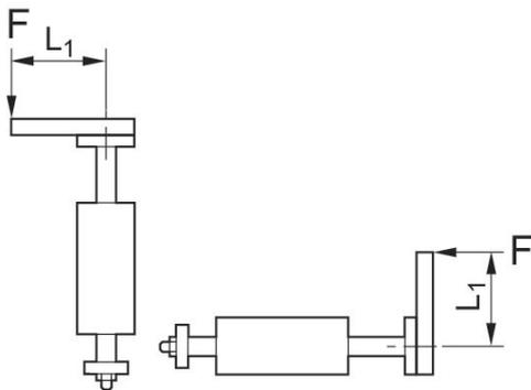
Longitud del brazo de palanca permitida  $L_1$  a 6 bar con carga estática
