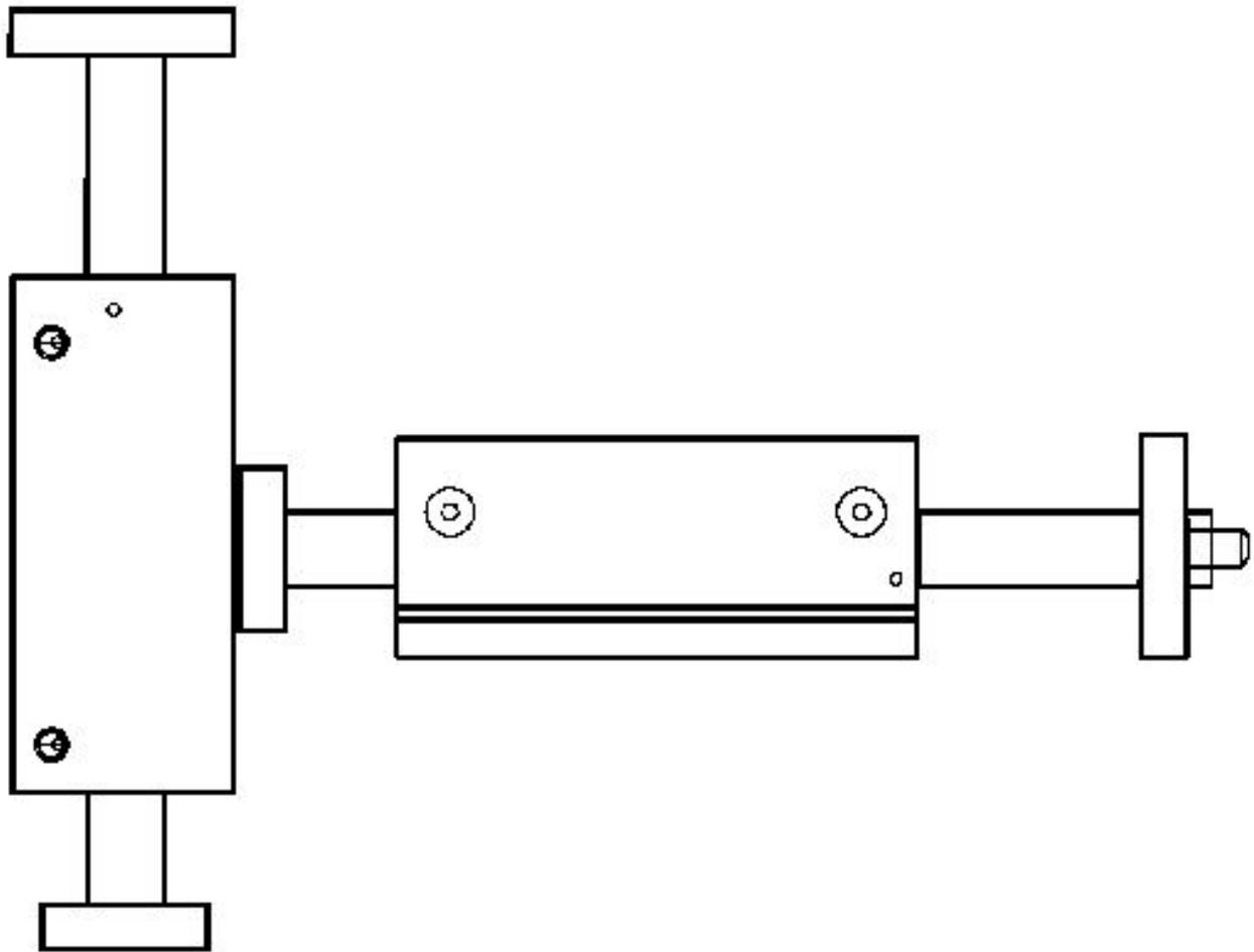
El GPC-E se puede montar directamente en la placa frontal del próximo GPC estándar más grande o GPC-E en dirección radial.
