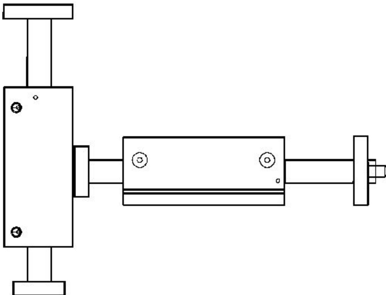
Il GPC-E può essere montato direttamente sulla piastra frontale del successivo GPC standard o GPC-E più grosso in direzione radiale.
