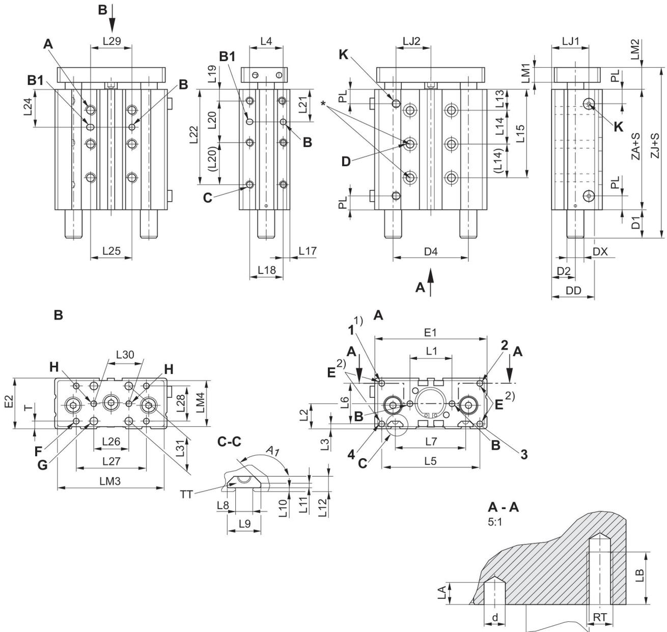
\* Adequado para parafusos segundo a norma ISO 4762
