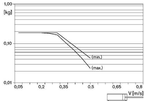
最大追加移動質量、(最小ストローク、最大ストローク)
