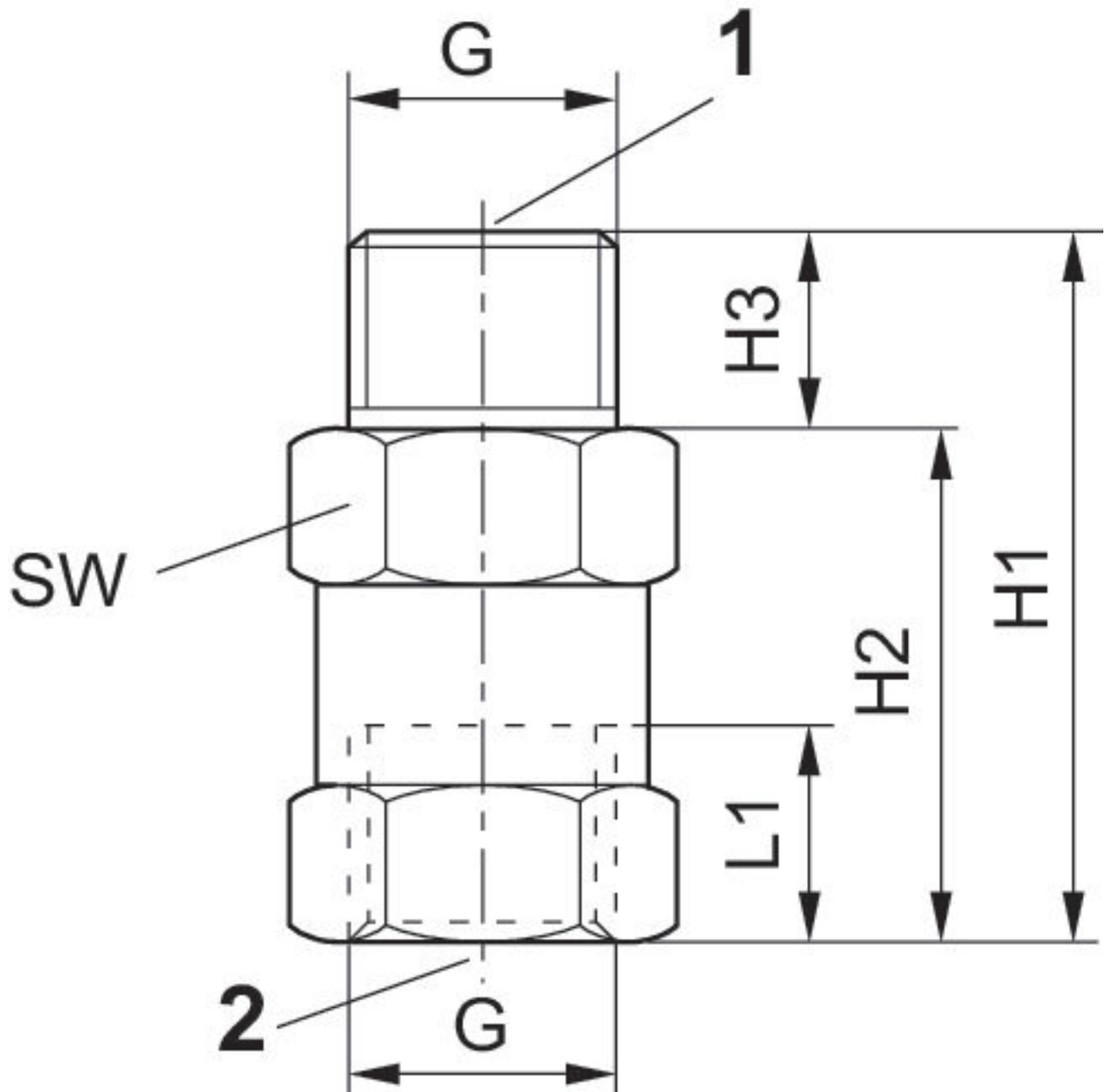
conexão 1 para ejetor a vácuo, conexão 2 para ventosa
