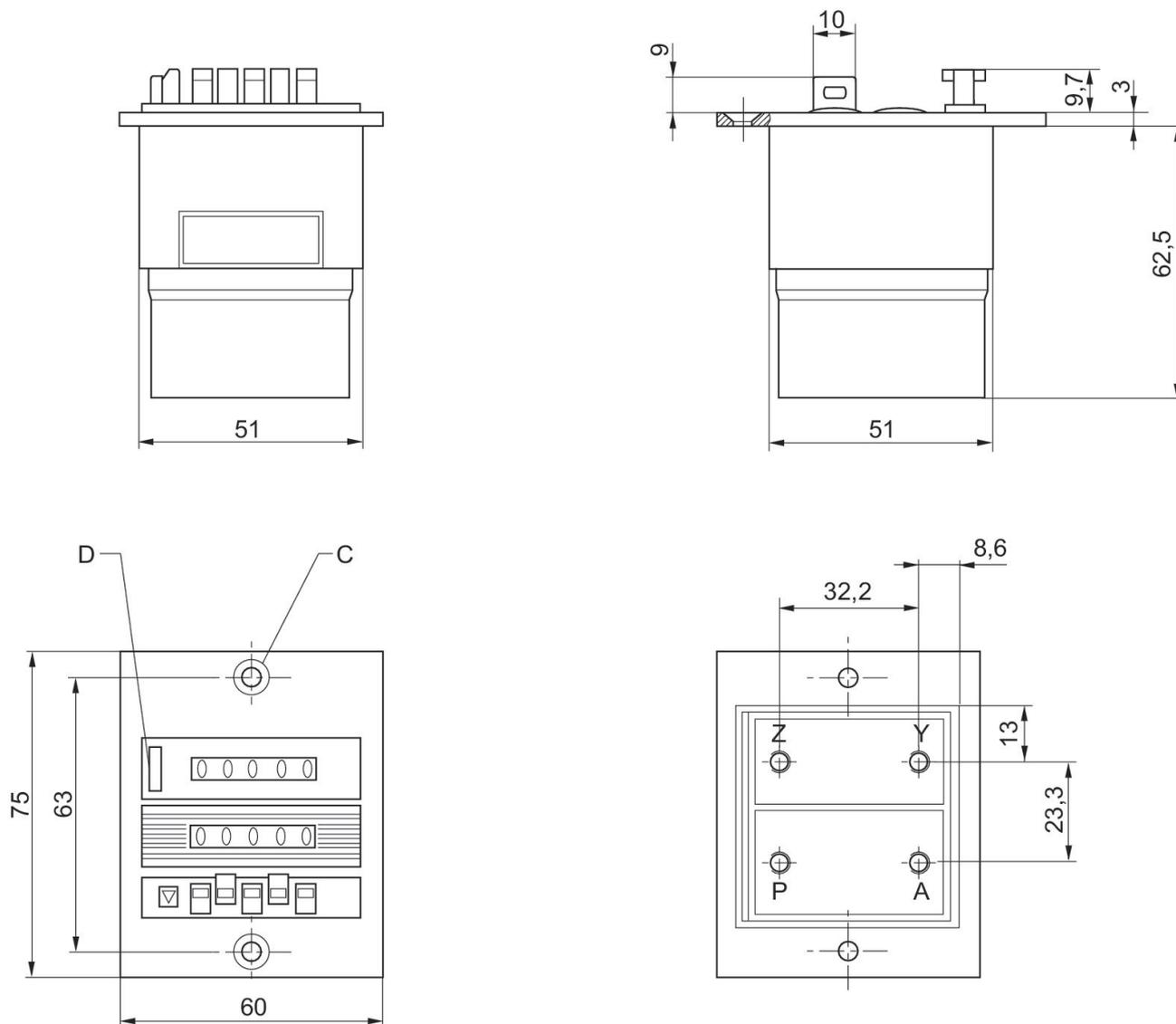
P (1) = raccord d'air comprimé
