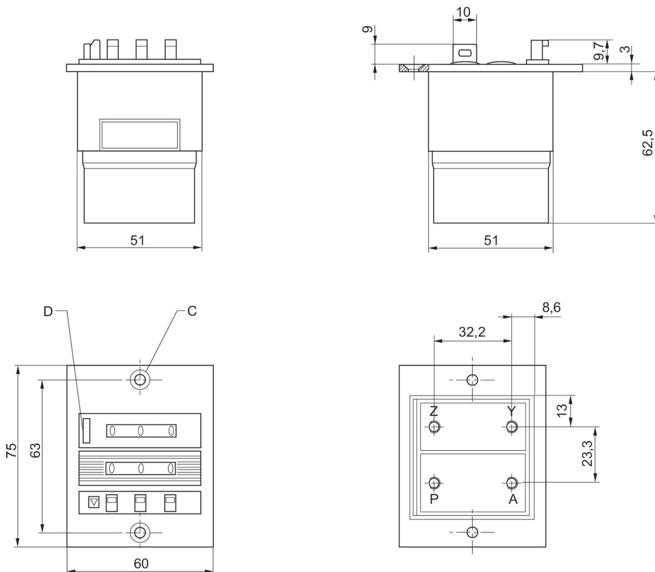
P (1) = raccord d'air comprimé
