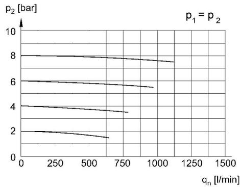
p<sub>2</sub> = Sekundärdruck q<sub>n</sub> = Nenndurchfluss
