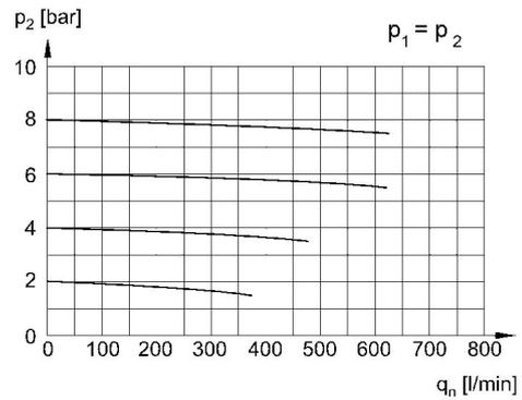
p<sub>2</sub> = Sekundärdruck q<sub>n</sub> = Nenndurchfluss
