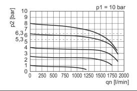
p1 = 作動圧力 p2 = 二次圧力 qn = 定格吐出
